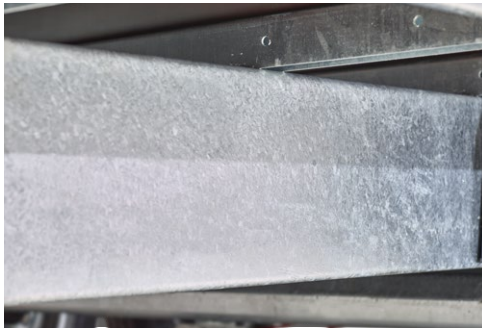
Rahmen und Fahrgestell Tauchbad feuerverzinkt
