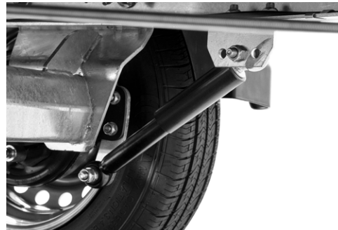
Radstoßdämpfer, für 100 km/h Ausführung (optional)
