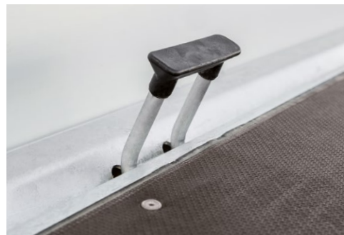
Serienmäßig im Außenrahmen integrierte Zurrbügel
