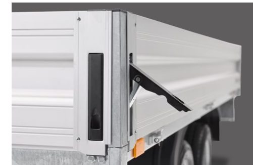
Klappe mit versenkten Verschlüssen
