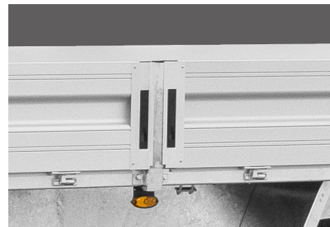
Montierte Mittelrungen an den seitlich geteilten Bordwänden (ab 6100 mm Innenlänge)
