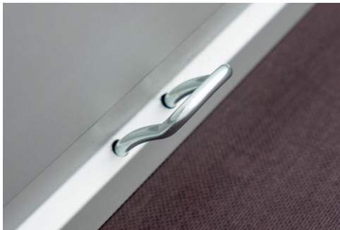
3 Paar in die Bordwand integrierte Verzurrösen mit je 400 kg Zugkraft
